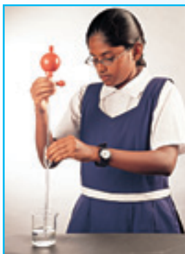
( ج ) تستخدم الماصة للقياس الدقيق
