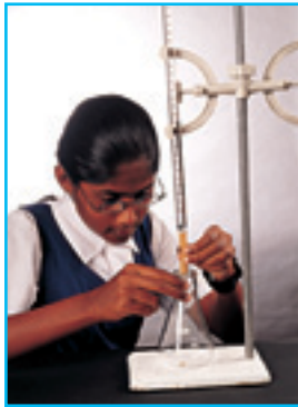
( ب ) عند قراءة سحاحة، تجنب خطأ اختلاف الرؤية
