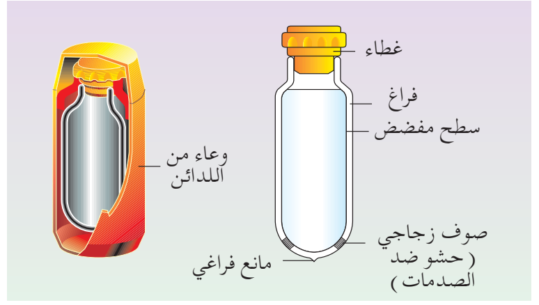
شكل 3-14 يُصمم دورق حفظ الحرارة (الترموس) خصيصاً لمنع انتقال الحرارة
