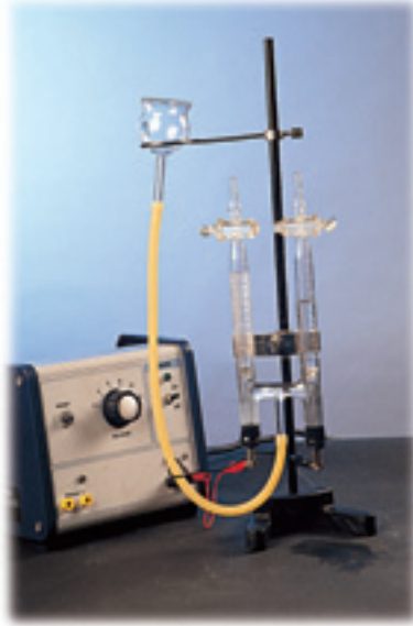
شكل 1-17 التحليل الكهربائي للماء الحمضي
