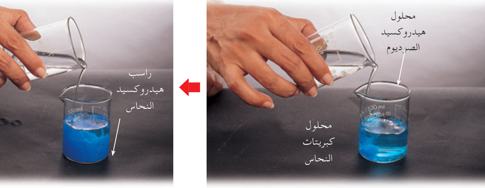
شكل 1-13 خلط محلول كبريتات النحاس مع محلول هيدروكسيد الصوديوم
