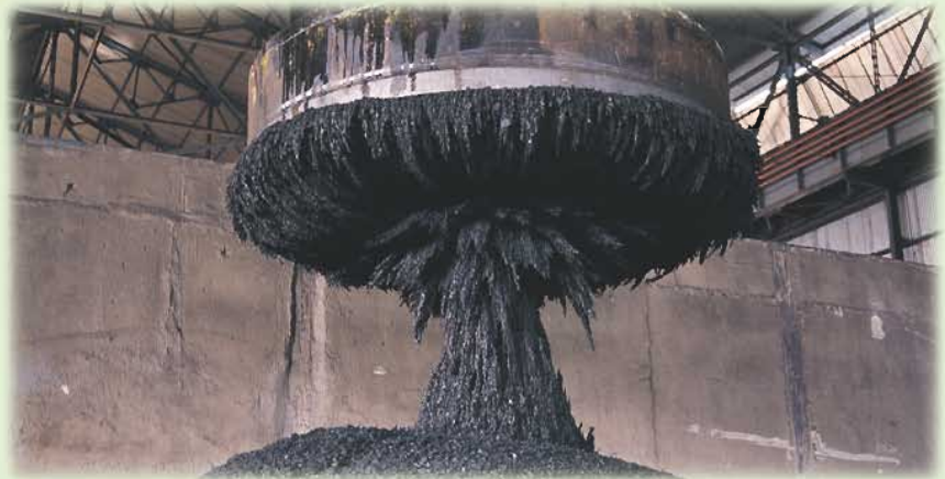
رافعة تلتقط الحديد الخردة باستخدام مغناطيس كهربائي
