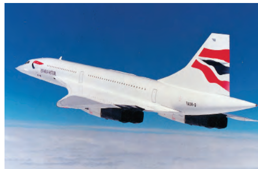
شكل 4 - 7 طائرة كونكورد - كان يصنع هيكلها من سبيكة ألومنيوم خفيفة الوزن ولكن متينة.
