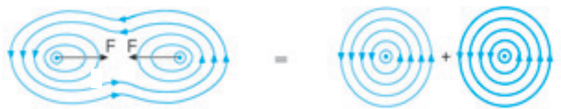
شكل 6 - 7 ب) توحيد مجالات مغناطيسية نتيجة تيارات في نفس الاتجاه.
