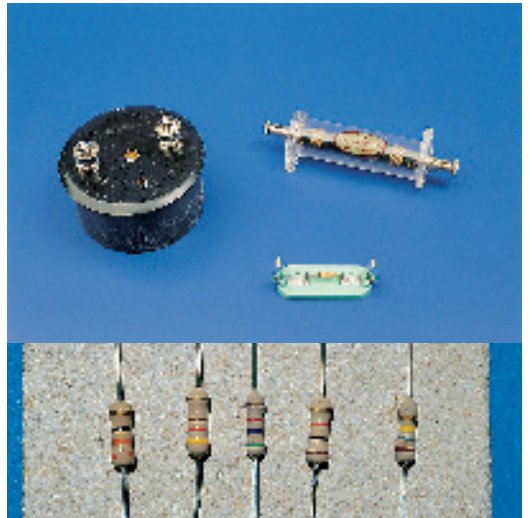
شكل 2 - 13 الأنواع المختلفة للمقاومات الثابتة
