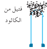
كاثود يُسخن بشكل مباشر
