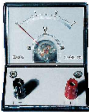
شكل 2 - 12 يقيس الفولتمتر القوة الدافعة الكهربائية أو فرق الجهد
