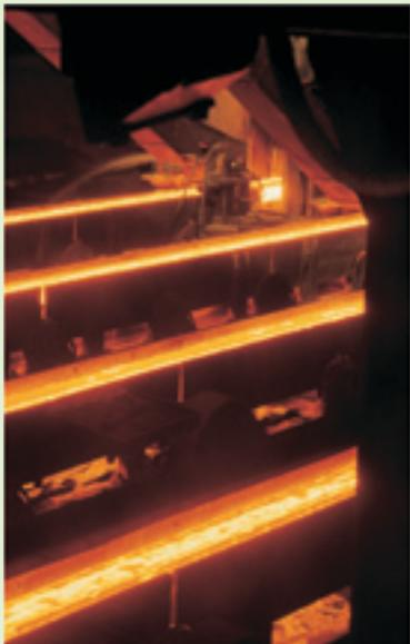
صناعة قضبان فولاذية داخل فرن الفولاذ
